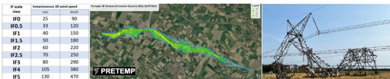
Fig. 8: Classificazione ESSL del tornado (sn); percorso del tornado (centro) e traliccio abbattuto (ds). Fonte: PRETEMP
